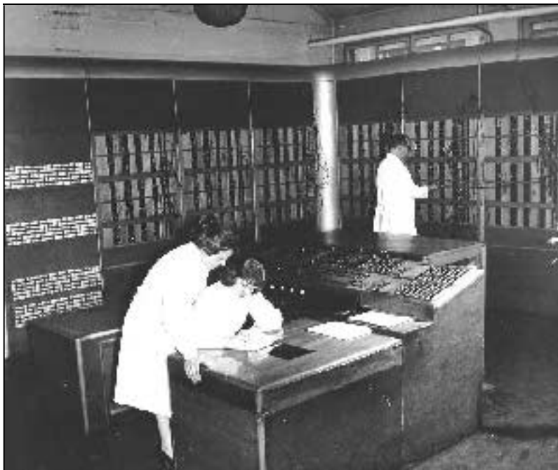
Abbildung 6: Arbeit am Commandopult der OPREMA; im Hintergrund wird ein Programm gesteckt.. Die Stecktafelprogrammierung macht deutlich, dass das von-Neumann-Prinzip noch nicht realisiert wurde.
